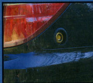
Hier kommt das Gas rein. Der Tankstutzen für den Flüssiggastank befindet sich unter dem Rücklicht.
